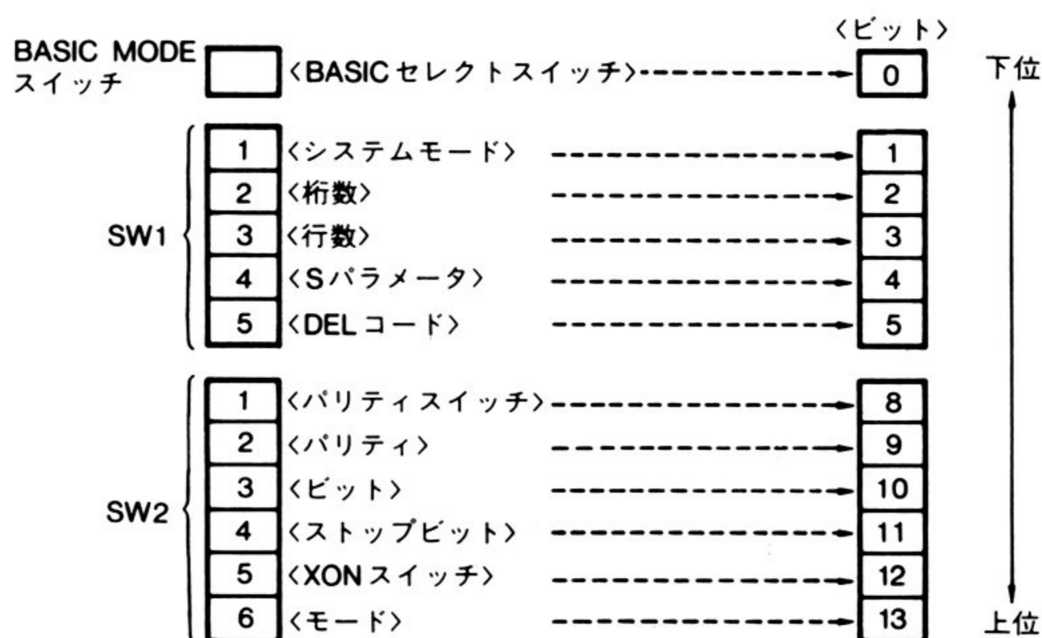
BASIC MODEスイッチおよびディップスイッチとの対応関係
